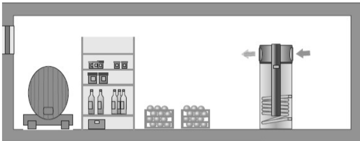
Fig. 6. Option d'Installation - prise et évacuation de l'air dans la même pièce (p. ex. refroidissement d'un garde-manger)
